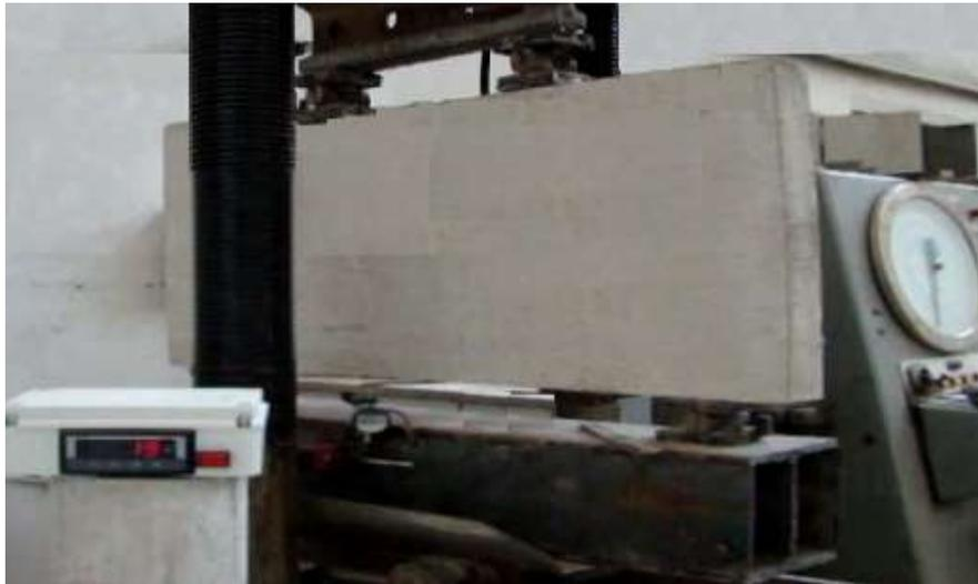
الشكل (5-40): توضع الجائز العميق المختبر على جهاز الاختبار.
